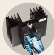
Commutation silencieuse du chauffage par relais à semi-conducteurs
