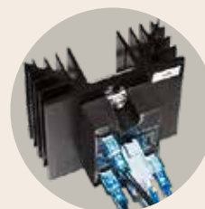
Chauffage à commutation silencieuse par relais semi-conducteurs
