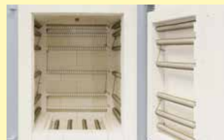
Chauffage sur cinq côtés et répartition spéciale des éléments chauffants pour une bonne répartition de la température
